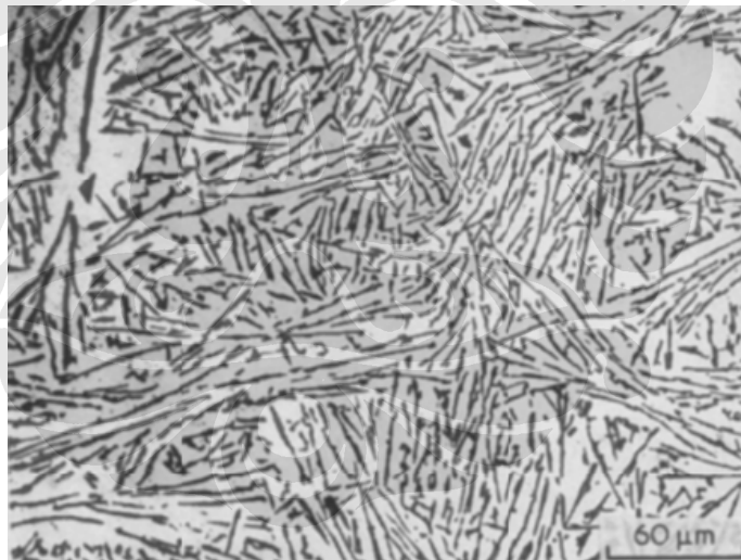
Gambar 2.4 Mikrostruktur paduan eutektik Al-Si. Etsa 0.5% HF dan Perbesaran 750x [10] .
