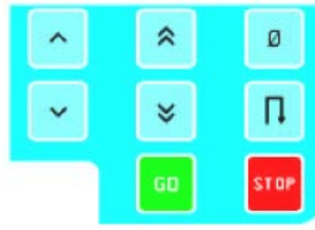
Gambar 2.20. Tombol kelompok pertama berfungsi mengatur gerakan dan posisi crosshead sebelum dan sesudah pengujian.
