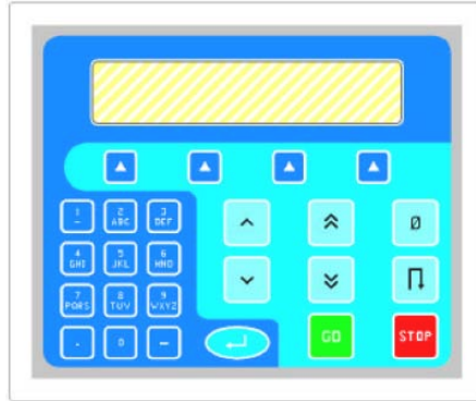
Gambar 2.19. Panel kontrol yang terdiri dari empat kelompok tombol kontrol.
