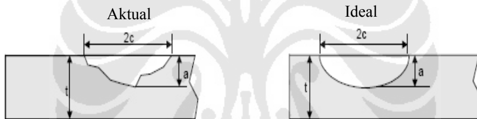
Gambar 5.5. Retak jenis surface-wall yang telah yang terjadi pada RFCCU [1]
