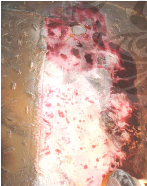
Titik No.2, ditemukan retak pada shell plenum lokasi (insert plate area) shell lama.
