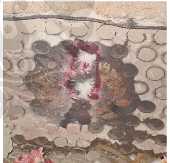
Titik No. 14 ( 180^\circ/\text{D-E} ) setelah dilakukan Penetrant Test pada lokasi shell plenum lama bagian atas header.
