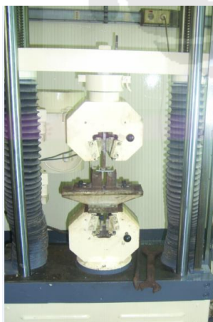
Gambar 3.11 Mesin Uji Bending, Pengatur Beban dan Pencatat Grafik Hasil Uji
