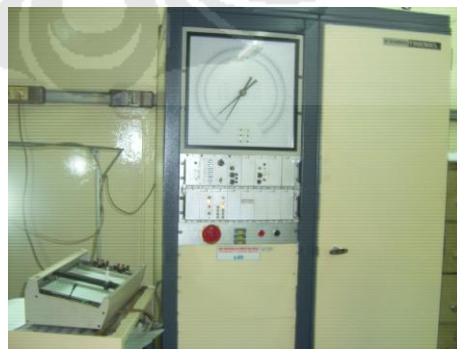
Gambar 3.11 Mesin Uji Bending, Pengatur Beban dan Pencatat Grafik Hasil Uji
