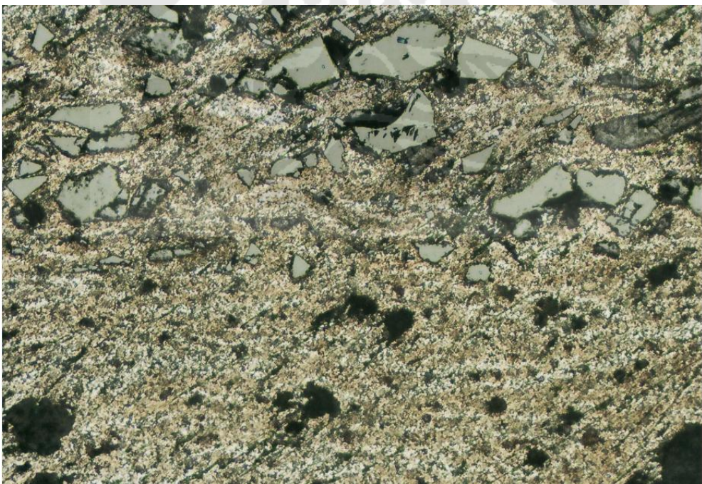
Temperatur Sinter 700°C, Waktu Sinter 6 Jam 40% Vf SiC/20% Vf Al 2 O 3
