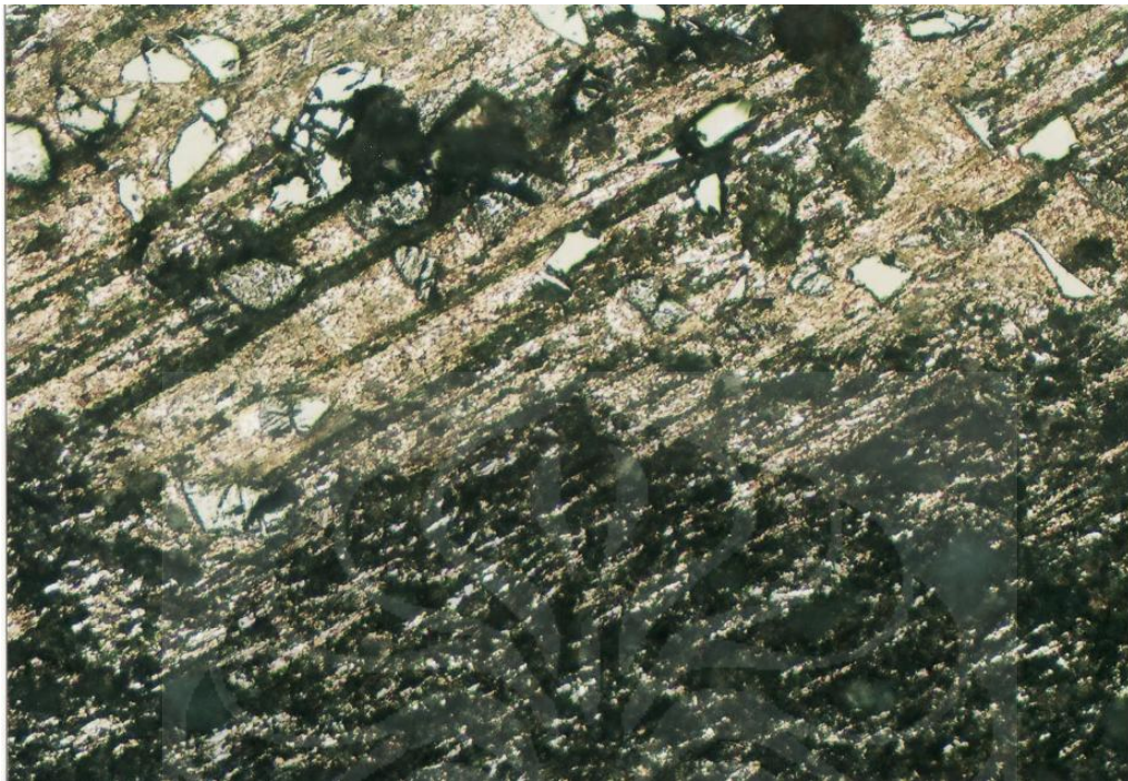
Temperatur Sinter 600°C, Waktu Sinter 6 Jam 40% Vf SiC/30% Vf Al 2 O 3
