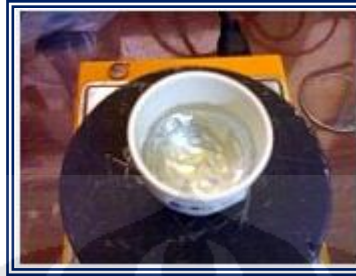
Gambar 3.6. Proses Pencampuran Matriks dan Penguat
