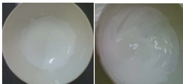
Gambar 4.9 Perbandingan pasta ZnO sebelum ditambah larutan \text{TiO}_2 (kiri) dan sesudah ditambah larutan \text{TiO}_2 (kanan)
