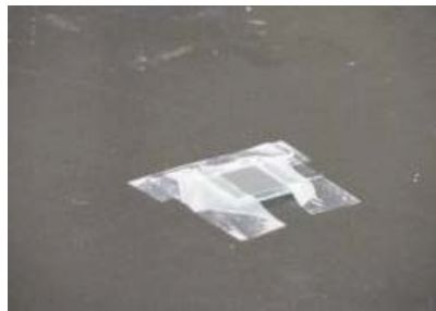
Gambar 3.8 TCO yang telah ditutup scotch tape
