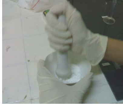
Gambar 3.3 Proses pelumpangan ZnO
