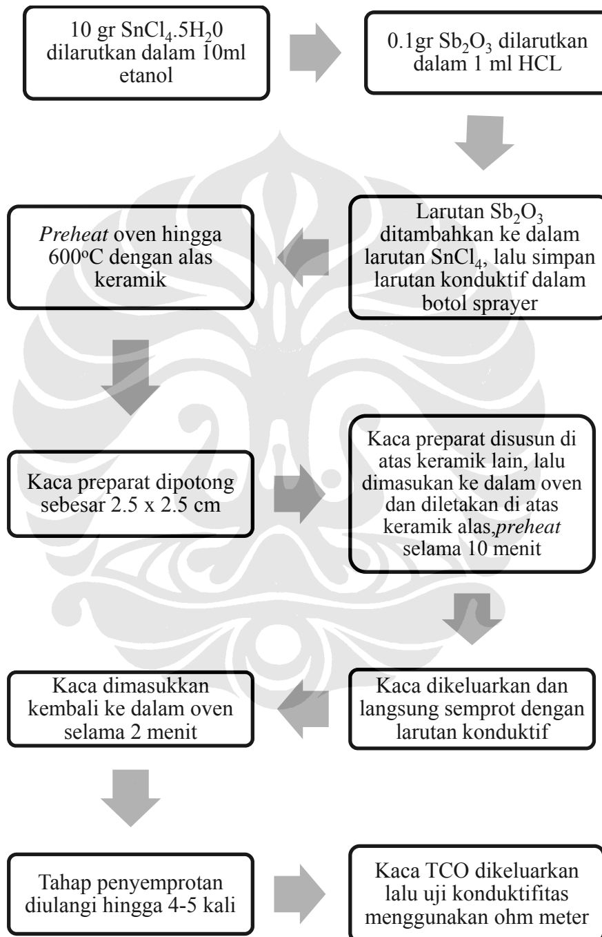
Gambar 3.2 Prosedur pembuatan TCO
