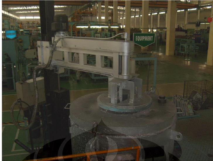
Gambar 3.5 Proses *Degassing* dengan Mesin GBF
