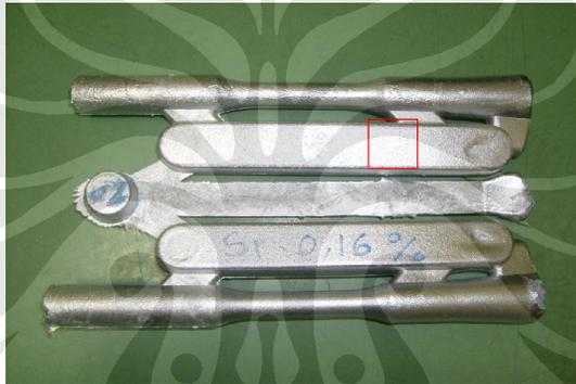
Gambar 3.11 Pengambilan Sampel untuk Pengamatan Foto Mikro
