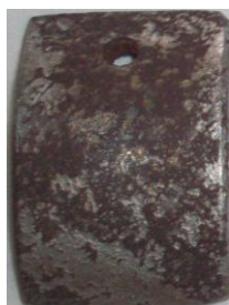
Gambar 4.2 Sampel Bare Steel Daerah Depok Evaluasi 21 Hari
