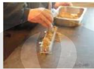
Gambar 3.5 Persiapan Sample Dengan Metode Soil Box
