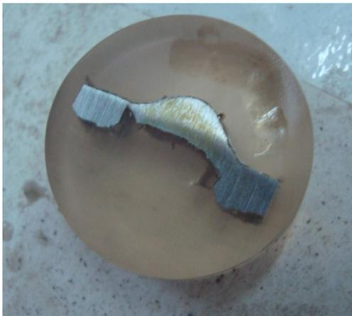
Gambar 3.4 Sampel yang digunakan dalam Pengamatan Metalografi
