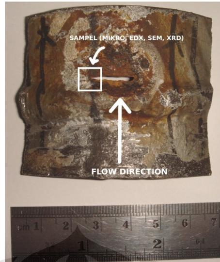
Gambar 3.3 Daerah pengambilan sampel uji untuk foto mikro, SEM/EDX, dan XRD
