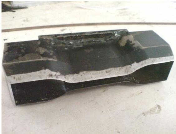
Gambar 3.2 Cetakan Spesimen (*Puncher*)
