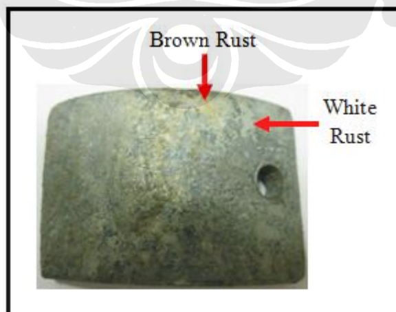
Gambar 4.11 White rust & Brown rust pada Baja Galvanis
