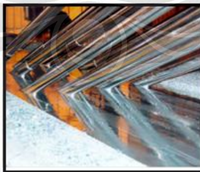
Gambar 2.14 Pengangkatan Produk dari Lelehan Zinc (8)
