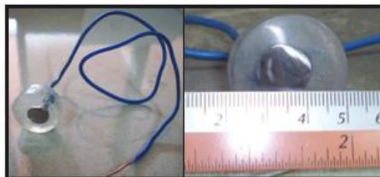
Gambar 3.7 Bentuk Sampel Uji Polarisasi
