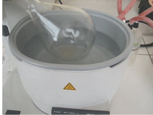
Gambar 13. Proses dispersi menggunakan Büchi Rotavapor Penangas air yang telah diisi air sehingga sebagian labu yang berisi liposom dan beads terendam
