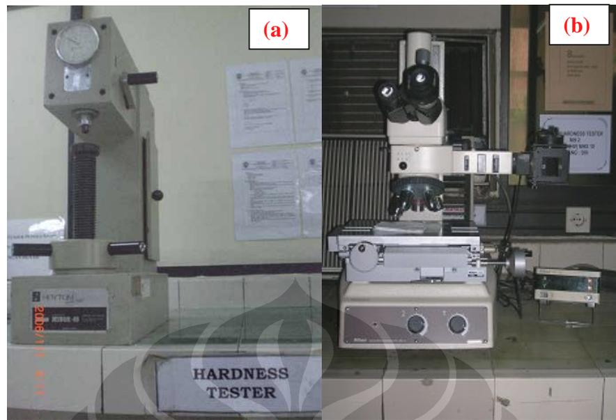
**Gambar 3.10.** Alat pengujian kekerasan: (a) mesin uji kekerasan metode Brinell Hoytom; (b) mikroskop pengukur.
