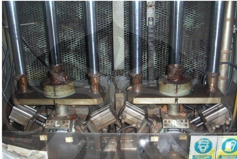
**Gambar 3.11.** Pengujian kebocoran pada *cylinder head*.
