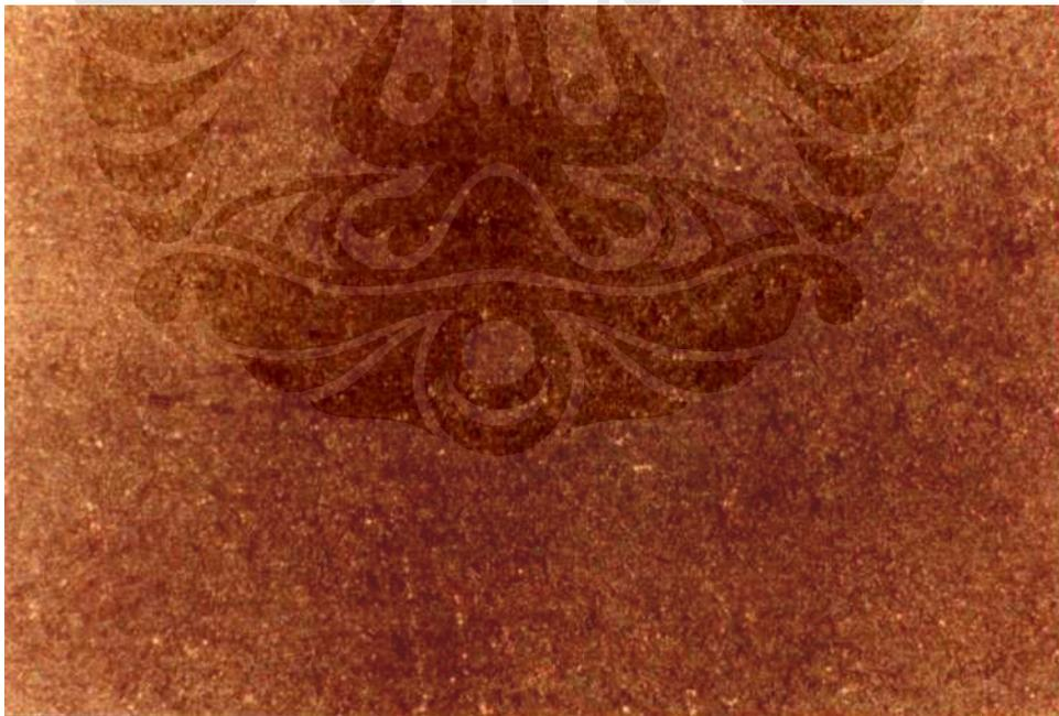
**Gambar 4.7** Foto Makro Sampel dengan Aplikasi Tegangan 61 MPa selama 72 jam (Perbesaran 30X)
