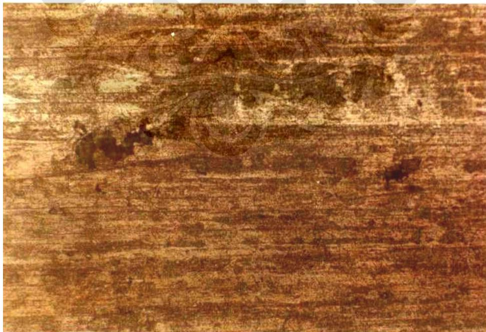
**Gambar 4.13** Foto Mikro Sampel dengan Aplikasi Tegangan 61 MPa selama 24 jam (Perbesaran 200X).
