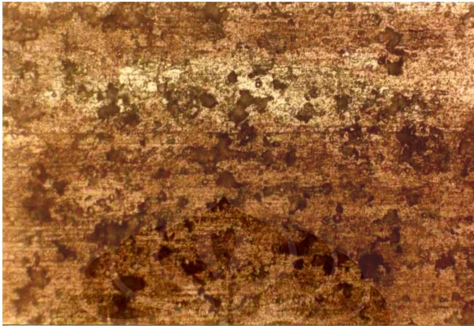
**Gambar 4.16** Foto Mikro Sampel dengan Aplikasi Tegangan 24 MPa selama 72 jam (Perbesaran200X).
