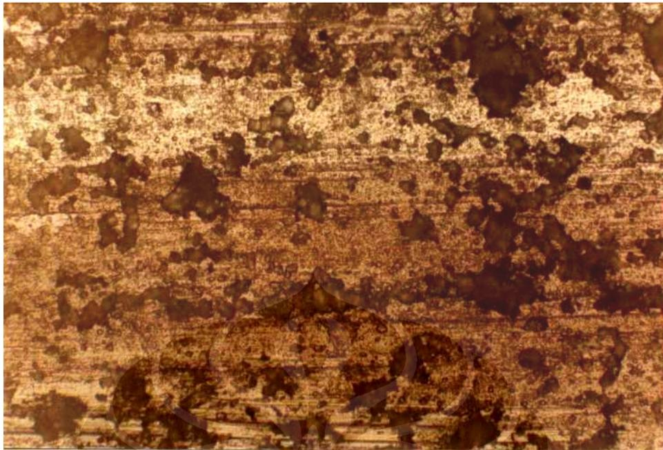
**Gambar 4.18** Foto Mikro Sampel dengan Aplikasi Tegangan 110 MPa selama 72 jam (Perbesaran200X).
