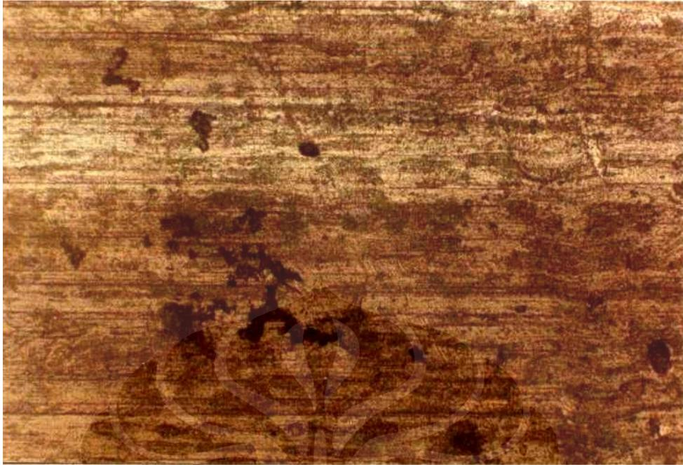
**Gambar 4.14** Foto Mikro Sampel dengan Aplikasi Tegangan 73 MPa selama 24 jam (Perbesaran30X).
