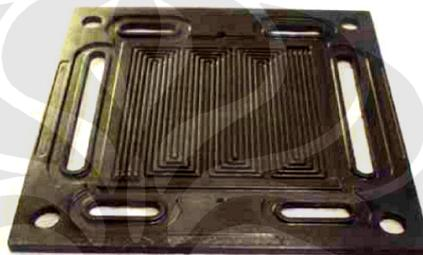
**Gambar 2.3** Pelat bipolar dengan saluran alir [16].
