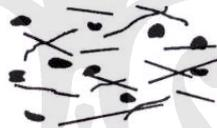
**Gambar 2.8** Komposit hibrida serat-partikulat (*fiber-particulate hybrids*) [21].
