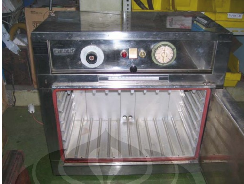
Gambar 3.3 Oven Memmert yang digunakan pada proses anil dan hidrotermal
