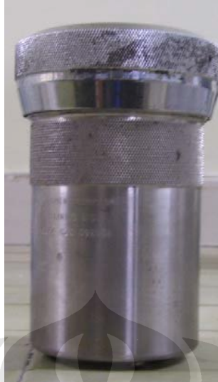
Gambar 3.4 Container yang digunakan pada proses hidrotermal
