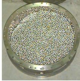
**Gambar 2.5.** Bola giling dan wadah penggilingan<sup>[18]</sup>
