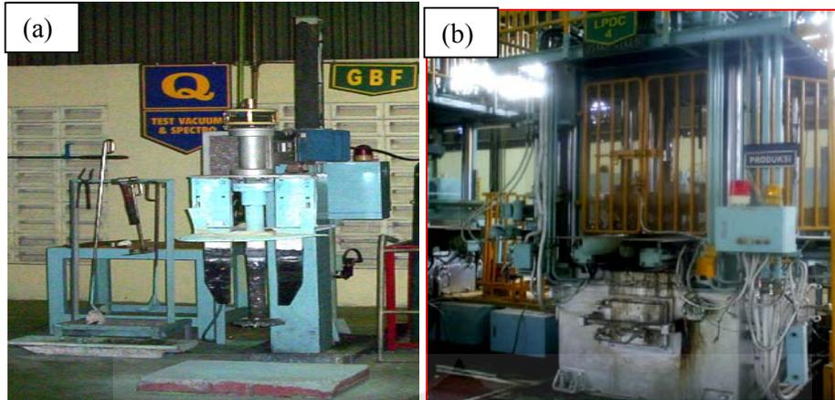
Gambar 3.2. (a) GBF; (b) Mesin LPDC dan *Holding Furnace*.
