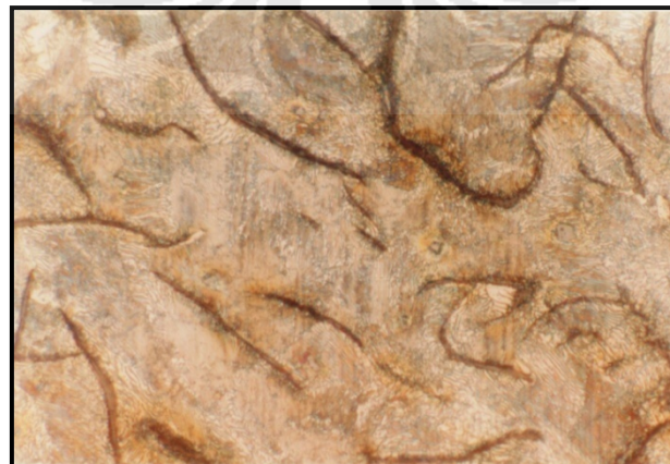
Gambar IV.14 Struktur Mikro Hasil Perlakuan Panas; Temperatur 100 0 C & Waktu Tahan 20 Menit. Perbesaran 500x, Dilakukan Etsa.
