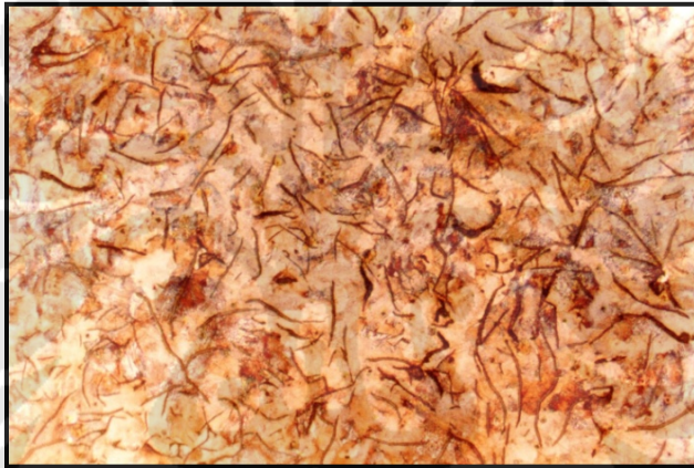
Gambar IV.28 Struktur Mikro Hasil Perlakuan Panas; Temperatur 200 0 C & Waktu tahan 30 Menit. Perbesaran 100x, Dilakukan Etsa.
