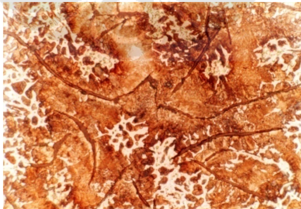
Gambar IV.44 Struktur Mikro Hasil Perlakuan Panas; Temperatur 800 0 C & Waktu Tahan 60 Menit. Perbesaran 100x, Dilakukan Etsa.
