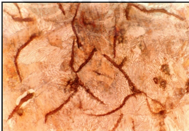
Gambar IV.17 Struktur Mikro Hasil Perlakuan Panas; Temperatur 100 0 C & Waktu Tahan 30 Tenit. Perbesaran 500x, Dilakukan Etsa.
