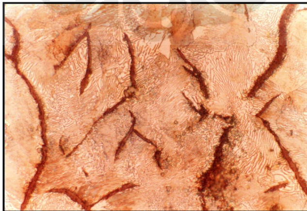
Gambar IV.23 Struktur Mikro Hasil Perlakuan Panas; Temperatur 200 0 C & Waktu Tahan 10 Menit. Perbesaran 500x, Dilakukan Etsa.
