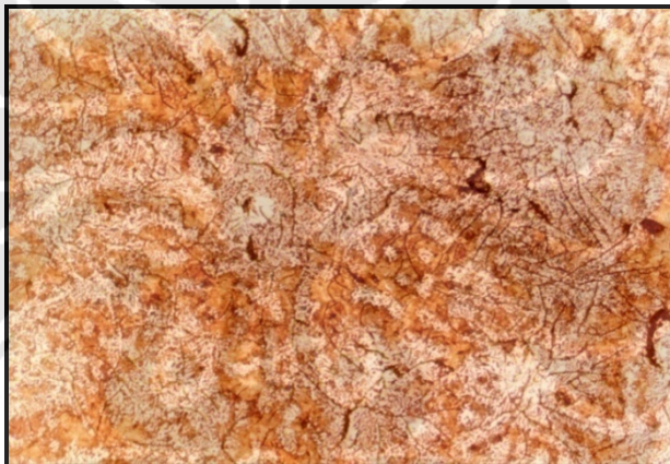
Gambar IV.40 Struktur Mikro Hasil Perlakuan Panas; Temperatur 800 0 C & Waktu Tahan 30 Menit. Perbesaran 100x, Dilakukan Etsa.
