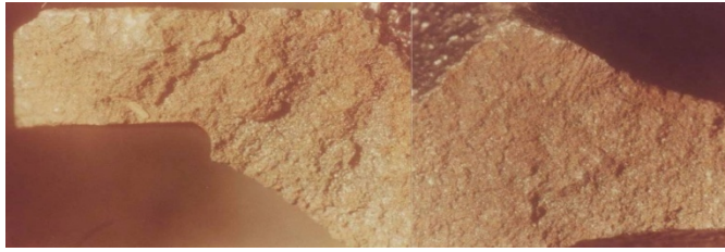
Gambar IV.1 Penampang Patahan Gardan Bagian Depan, Perbesaran 7kali
