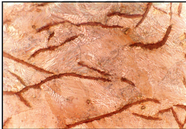
Gambar IV.26 Struktur Mikro Hasil Perlakuan Panas; Temperatur 200 0 C & Waktu Tahan 20 Menit. Perbesaran 500x, Dilakukan Etsa.
