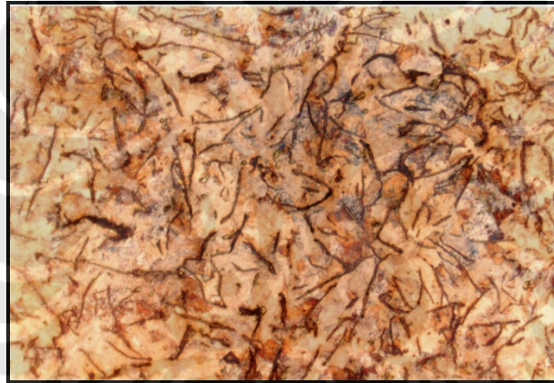
Gambar IV.25 Struktur Mikro Hasil Perlakuan Panas; Temperatur 200 0 C & Waktu Tahan 20 Menit. Perbesaran 100x, Dilakukan Etsa.
