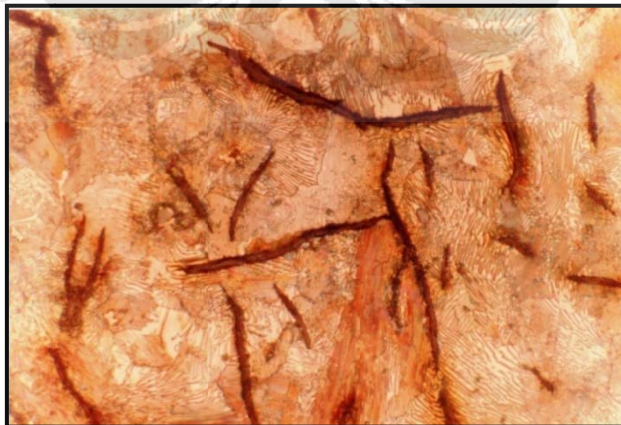
Gambar IV.32 Struktur Mikro Hasil Perlakuan Panas; Temperatur 200 0 C & Waktu Tahan 60 Menit. Perbesaran 500x, Dilakukan Etsa.
