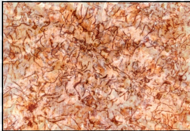
Gambar IV.13 Struktur Mikro Hasil Perlakuan Panas; Temperatur 100 0 C & Waktu Tahan 20 Menit. Perbesaran 100x, Dilakukan Etsa.
