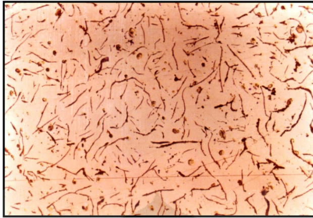
Gambar IV.21 Struktur Mikro Hasil Perlakuan Panas; Temperatur 200 0 C & Waktu Tahan 10 Menit. Perbesaran 100x, Tanpa Dilakukan Etsa.
