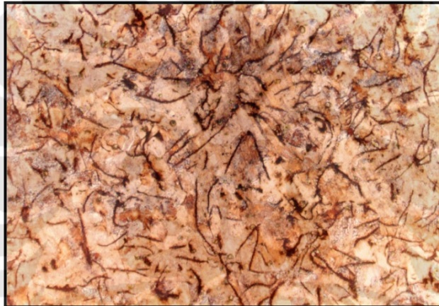
Gambar IV.22 Struktur Mikro Hasil Perlakuan Panas; Temperatur 200 0 C & Waktu Tahan 10 Menit. Perbesaran 100x, Dilakukan Etsa.
