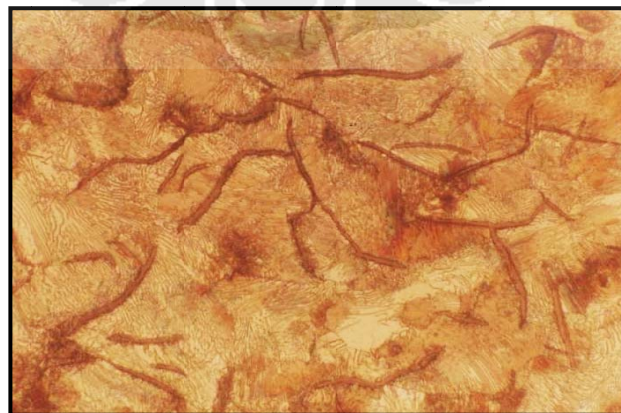
Gambar IV.8 Struktur Mikro Sampel Awal. Perbesaran 500x, Dilakukan Etsa.
