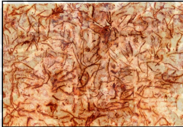
Gambar IV.31 Struktur Mikro Hasil Perlakuan Panas; Temperatur 200 0 C & Waktu tahan 60 menit. perbesaran 100x, dilakukan etsa.
