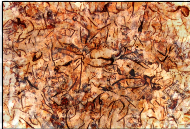
Gambar IV.19 Struktur Mikro Hasil Perlakuan Panas; Temperatur 100 0 C & Waktu Tahan 60 Menit. Perbesaran 100x, Dilakukan Etsa.
