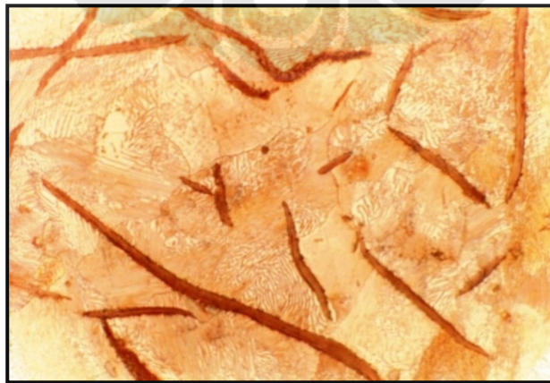
Gambar IV.20 Struktur Mikro Hasil Perlakuan Panas; Temperatur 100 0 C & Waktu Tahan 60 Menit. Perbesaran 500x, Dilakukan Etsa.
