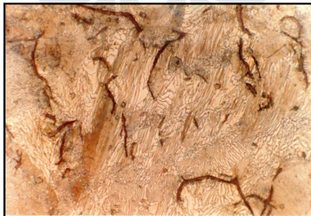
Gambar IV. Struktur Mikro Hasil Perlakuan Panas; Temperatur 100 0 C & Waktu Tahan 10 Menit. Perbesaran 100x, Dilakukan Etsa.
