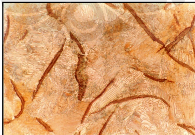
Gambar IV.29 Struktur Mikro Hasil Perlakuan Panas; Temperatur 200 0 C & Waktu Tahan 30 Menit. Perbesaran 100x, Dilakukan Etsa.
