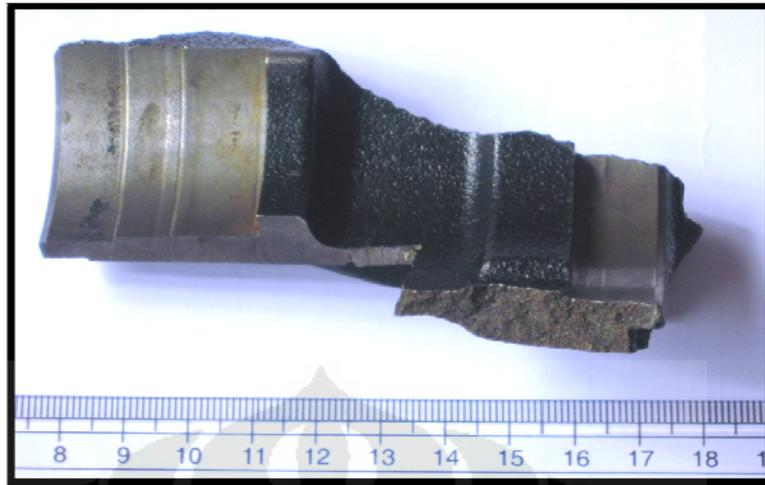
**Gambar III.4.** Pecahan *Housing* Gardan bagian 1 Tampak Kiri
