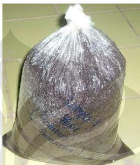
Gambar 3.4 contoh tanah uji yang telah disaring
