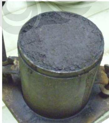
Gambar 3.11 Tanah gambut setelah mengalami proses pengeringan 4 hingga 7 hari
