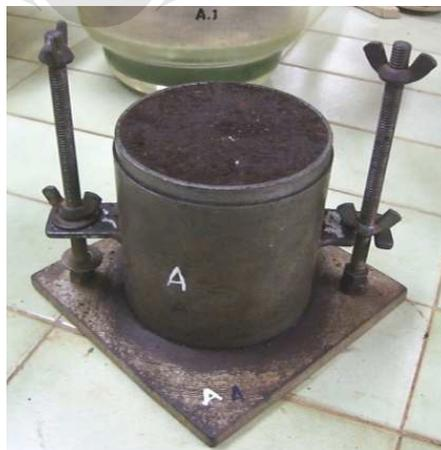
Gambar 3.8 tanah gambut yang telah dipadatkan
