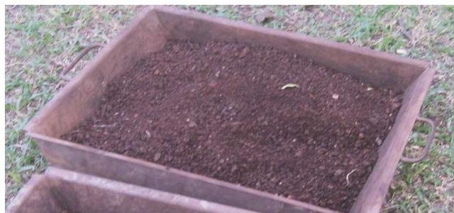
Gambar 3.2 proses penjemuran tanah uji
