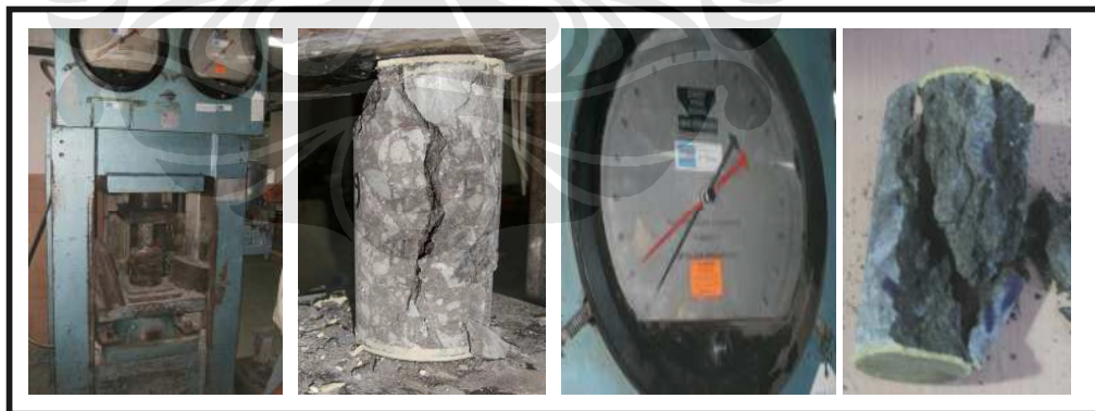
Gambar 7. Proses dan Hasil pengujian kuat tekan pada sample core drill
