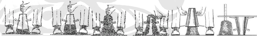
Gambar 3.8 Pengujian slump test
