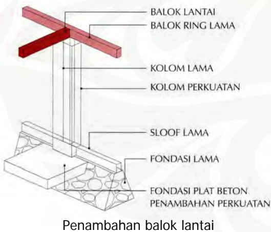
Gb.3.9 Penambahan struktur saat renovasi
