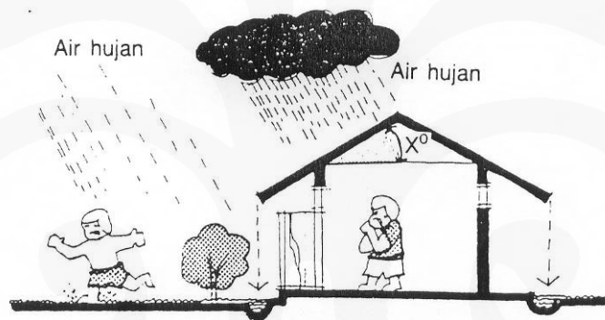
Gb.3.10 Atap rumah di daerah tropis harus mampu meneruskan air hujan jatuh ke tanah
