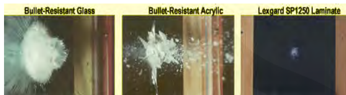
Gambar II.35. Perbandingan kaca lapis, akrilik lapis dan polikarbonat lapis pada uji tembak Sumber : www.plasticrafts.com
