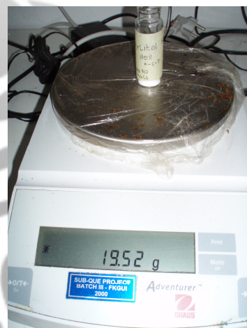
Penimbangan 1,52 gram Bubuk Xylitol (+ 18 gram berat botol) dengan Timbangan Ohaus Adventurer (dalam gram) untuk Pembuatan Larutan Xylitol 5%.
