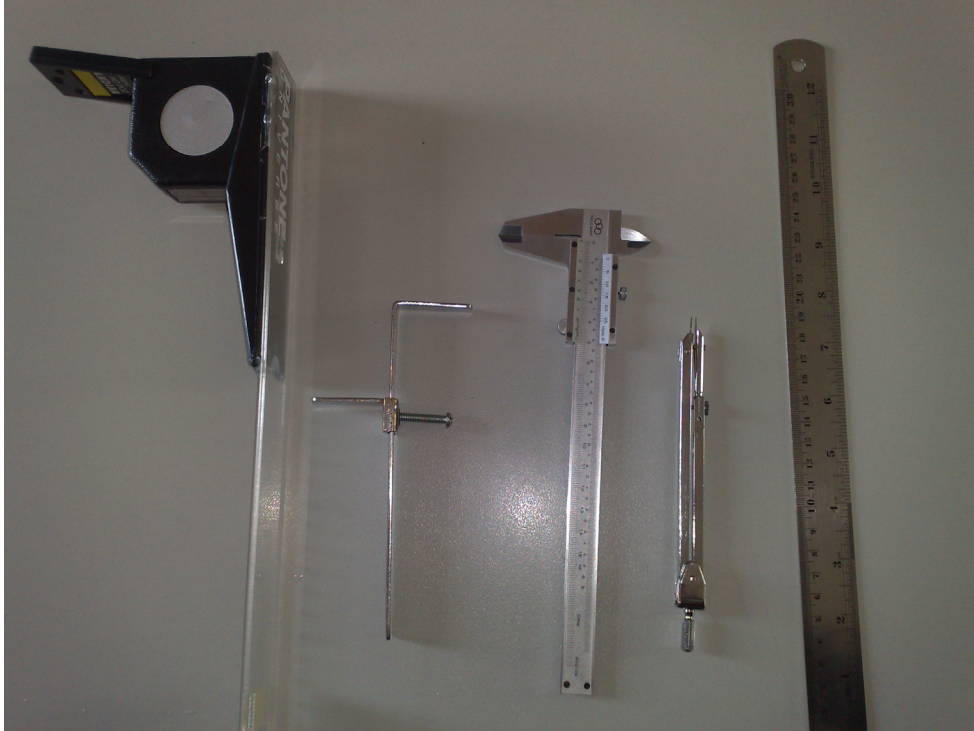
Gambar Instrumen yang digunakan (kiri-kanan): Alat Pengukur Tinggi Badan, Boley Gauge, Jangka Sorong, Jangka, Penggaris
