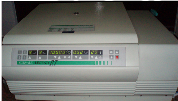
Proses sentrifugasi untuk memurnikan C. albicans dengan 10.000 rpm selama 2 menit
