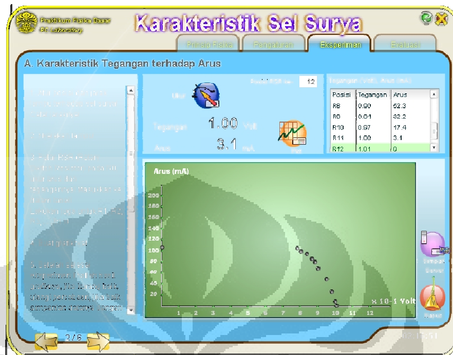
Gambar 4.9 Plot data karakteristik arus-tegangan sel surya dengan PC
