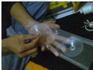
Gambar III.16: Cara pemasangan perekat pada casing Pump Toothpaste Dispenser
