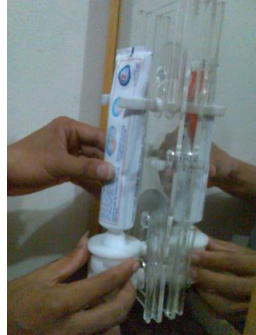
Gambar III.20 : Cara memasang pasta gigi pada Pump Toothpaste Dispenser
