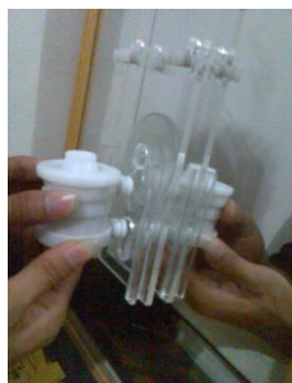
Gambar III.19: Cara meletakkan pompa Pump Toothpaste Dispenser pada casing
