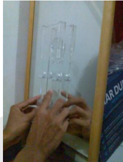
Gambar III.17 : Cara pemasangan casing Pump Toothpaste Dispenser pada kaca
