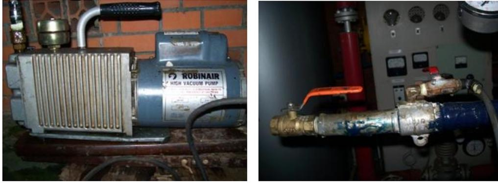
**Gambar 3.13** Pompa vakum dan ejektor udara
