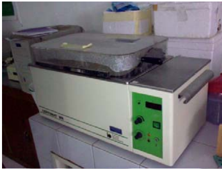
Penangas air untuk pengocokan tube Eppendorf yang berisi kitosan dan C. albicans pada suhu 37^{\circ}\text{C} selama 3 jam
