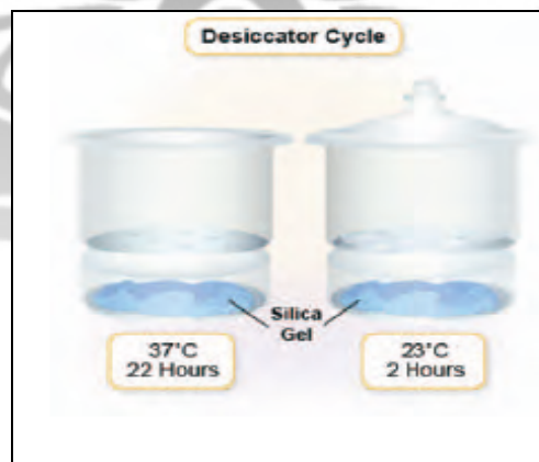
Gambar 4.2. Dua desikator dengan silika gel di dasar tabung dan spesimen di atasnya
