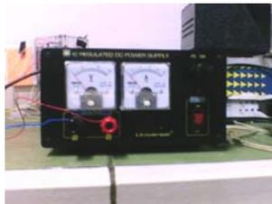
Gambar 4.6. Power supply untuk *Heat Pipe* dan Peltier
