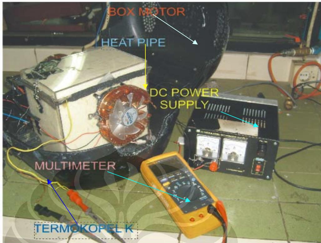
Gambar 4.2 instalasi alat pengujian
