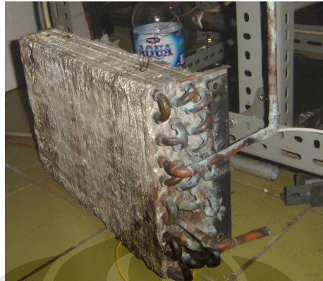
Gambar 4.12. Foto condenser lama yang mengalami kebocoran
