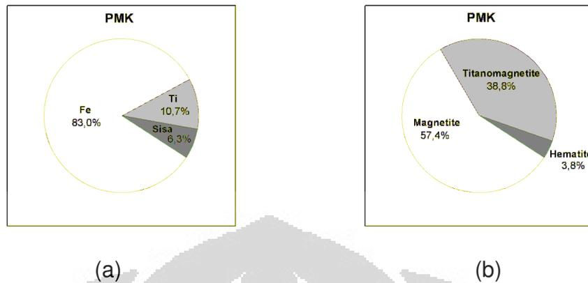
Gambar 4.4 Komposisi massa (a) unsur hasil XRF dan (b) senyawa analisa XRD pada PMK
