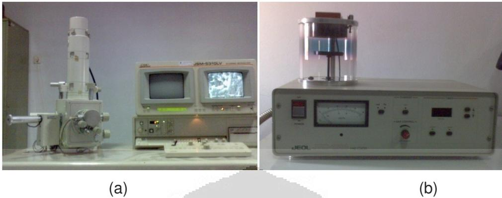
Gambar 3.4 (a) SEM, dan (b) alat pelapis emas untuk sampel SEM
