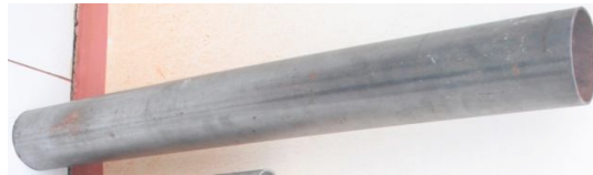
Gambar 3.15. Pipa sebagai bahan baku pembuatan reservoir
