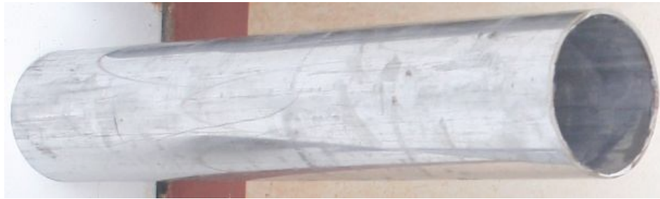
Gambar 3.5. Pipa stainless steel sebagai bahan dasar pipa-luar evaporator
