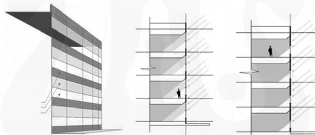
Gambar.26 Ilustrasi *Curtain wall*.
