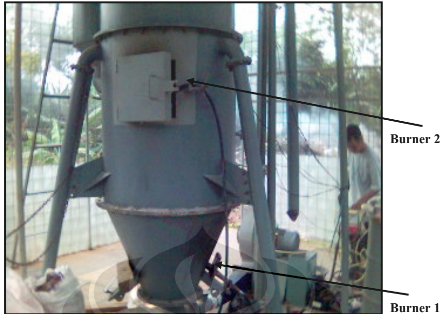
Gambar 4.4. Mekanisme sistem burner yang sebelumnya digunakan
