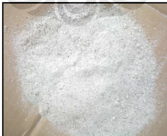
Gambar 5.1. Pasir silika mesh 30-50 yang digunakan pada fluidized bed incinerator UI
