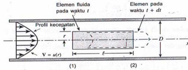
**Gambar 2.7** Gerakan elemen fluida silindris di dalam sebuah pipa
