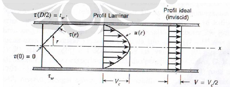
**Gambar 2.9** Distribusi tegangan geser pada fluida di dalam sebuah pipa (aliran laminar atau turbulen) dan profil-profil kecepatan yang khas
