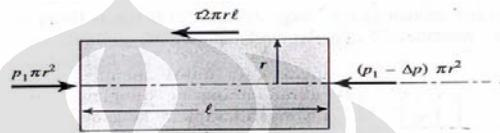
**Gambar 2.8** Diagram benda-bebas dari silinder fluida
