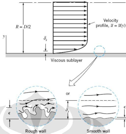
**Gambar 2.5** Aliran pada sublapisan viskos (*viscous sublayer*) di dekat dinding kasar dan mulus
