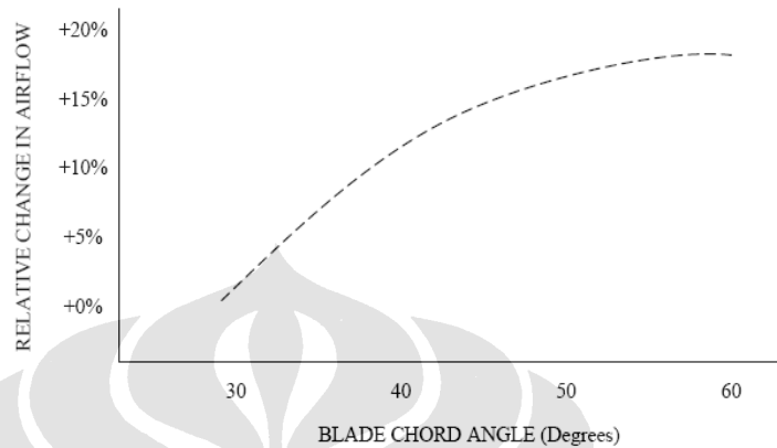
Gambar 2.13 pengaruh perubahan sudut blade terhadap perubahan aliran udara
