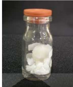
Gambar 4.4 Magnesium klorida padatan yang terbentuk setelah pemanasan selama 9 menit
