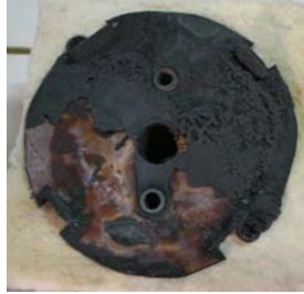
Gambar 4.10 Tutup wadah dari stainless steel setelah pengujian
