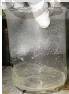
Gambar 4.2 Larutan magnesium klorida hasil reaksi antara bubuk hidromagnesit dengan larutan \text{HCl}
