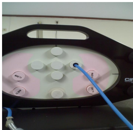
Gambar 3.5 : Foto Peletakan Bilik Ionisasi Farmer pada Fantom
