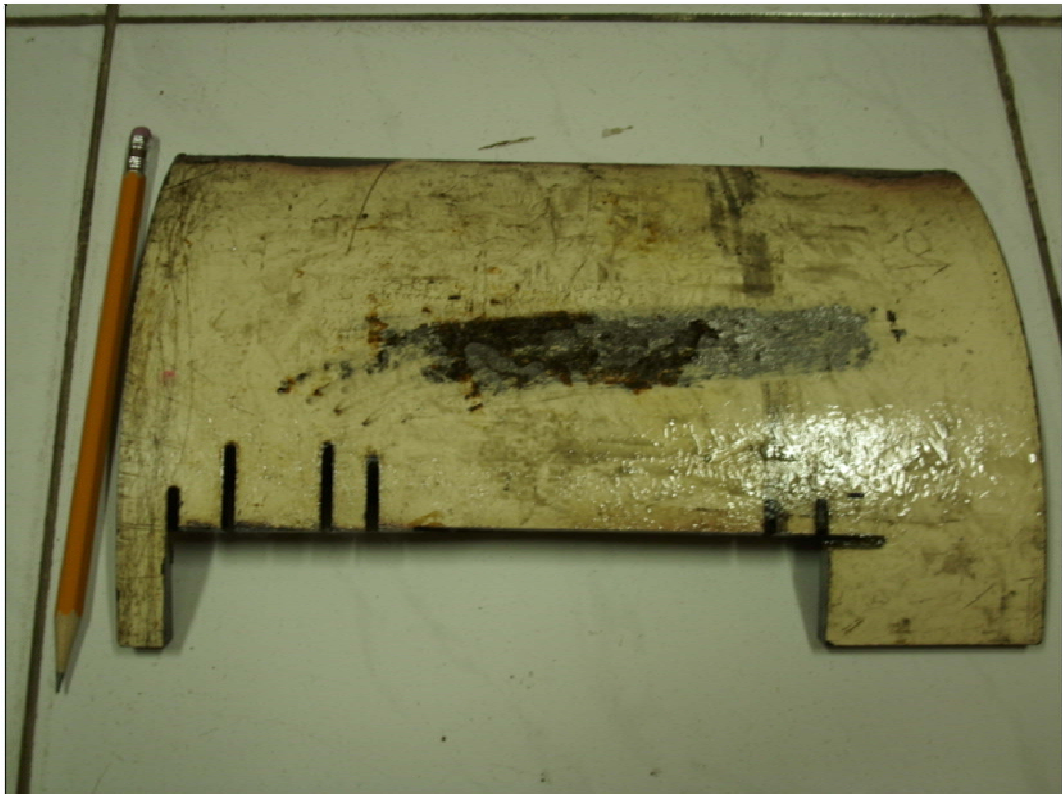
Gambar 4.5 Potongan logam tabung CNG sebagai percobaan
